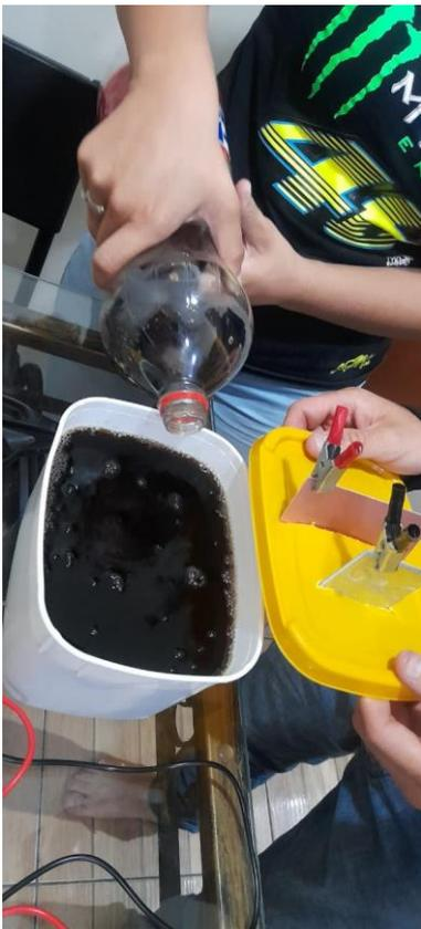
**Figura 5.** O recipiente contendo refrigerante é tampado com o sistema já montado. Mede-se a diferença de potencial do sistema.
