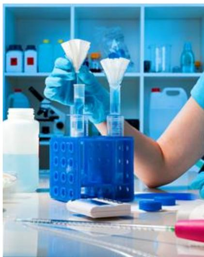
Equipamentos utilizados em uma filtração Simples
