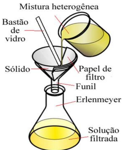
Equipamentos utilizados em uma filtração Simples
