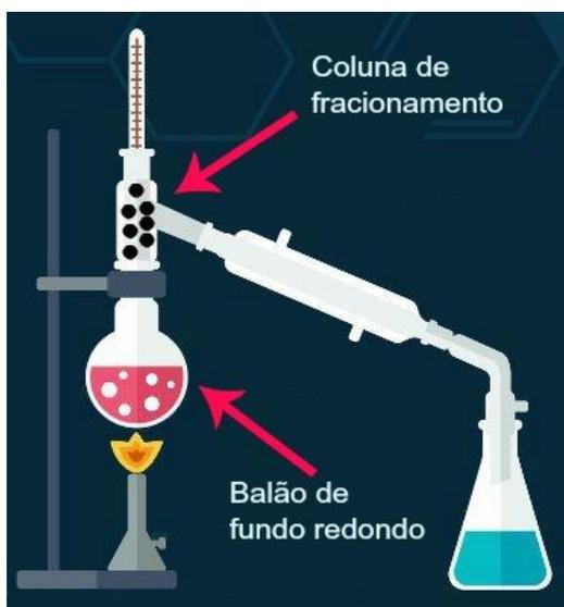
Representação dos equipamentos necessários em uma destilação fracionada
