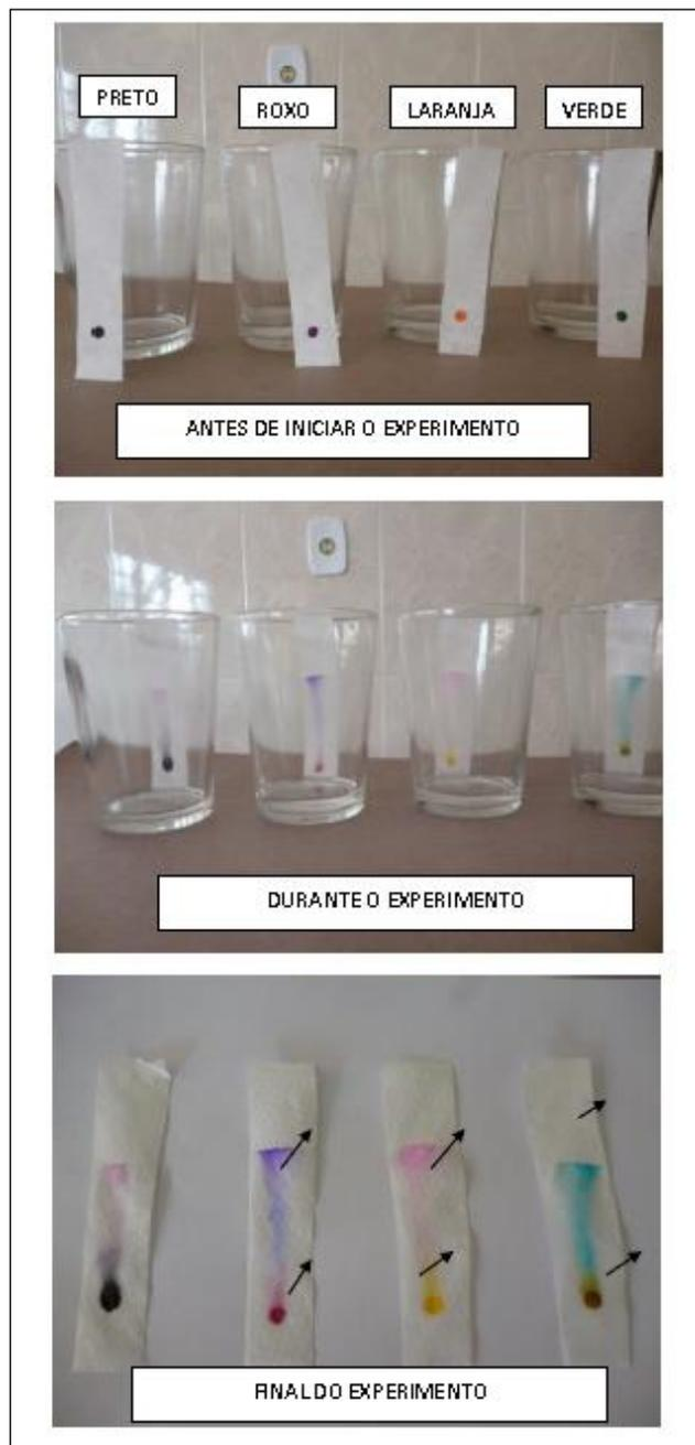
**Figura 2:** Sequência da cromatografia de canetas hidrocolor em álcool
